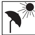
Тахеометр нужно защищать от прямых солнечных лучей, во избежание его нагрева. Не рекомендуется производить поверки при сильных колебаниях воздуха и атмосферной турбулентности. Наилучшие условия обычно рано утром или при затянутом облаками небе.
